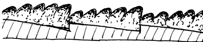
В. Передние корпуса плуга заглублены больше, чем задние
